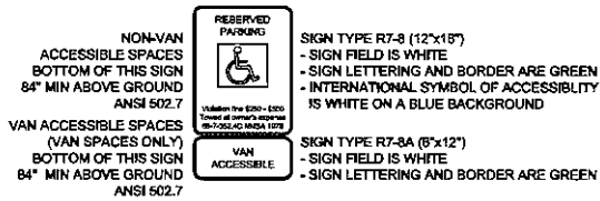
ACCESSIBLE SIGN DETAIL SCALE: N.T.S.
